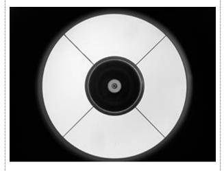
Vergleichen Sie bitte nebenstehendes Bild mit dem Bild aus Schritt 7. Wenn zwischen beiden Kreisen ein sehr dünner weißer Ring gleichmäßig zu sehen ist, dann ist der Hauptspiegel und damit das ganze RC-System justiert. Je nach Typ ist der weisse Ring nicht immer zu sehen. Es wird dann auf den größeren dunklen Ring justiert.
