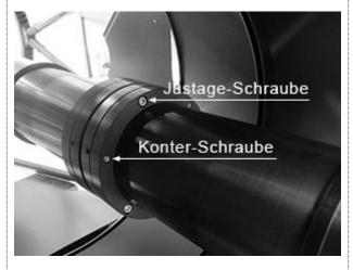
Schritt 10 - Hauptspiegel Blendrohr-Justage
